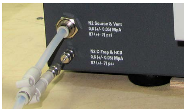
Abbildung 5-1. An den Gasanschlüssen angebrachtes Y-Anschlussstück
