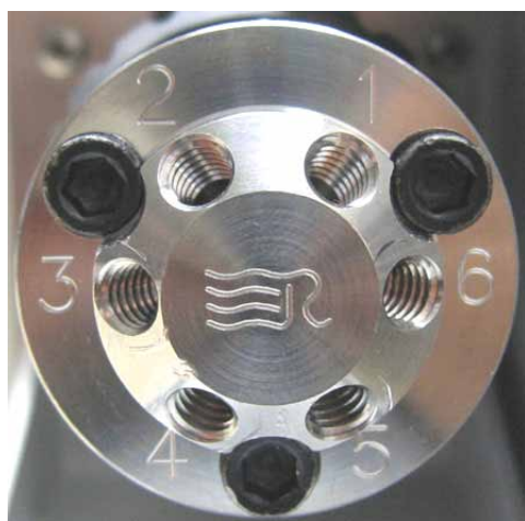
Abb. 26: Beispiel für die Anschlüsse an einem Säulenschaltventil mit 2 Positionen und 6 Ports
