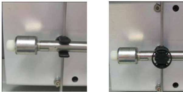
Abb. 21: Einsetzen der Säule
