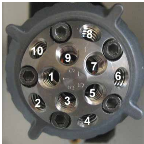
Abb. 27: Beispiel für die Anschlüsse an einem Säulenschaltventil mit 2 Positionen und, 10 Ports
