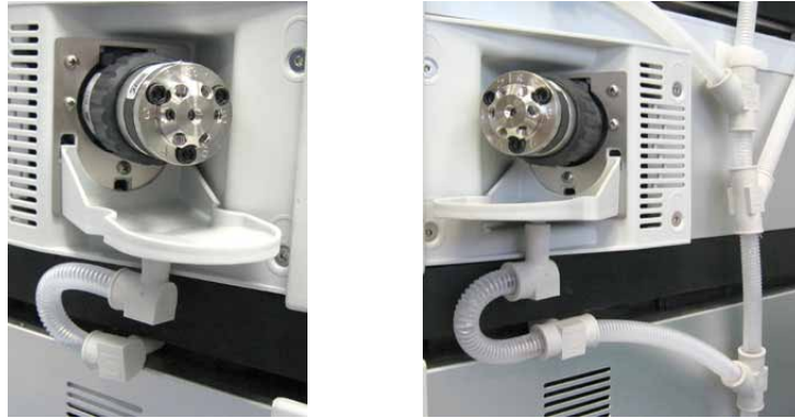
Abb. 16: Drainagewanne mit Ablaufschlauch Anschluss am linken bzw. rechten Ventil
